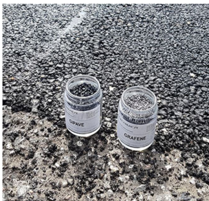
Gipave: un supermodificante polimerico contenente anche grafene
